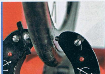
**2** Ist dies nicht oder auch sehr stark der Fall, stellen Sie nach, bis der Fühler leicht streift. Kontrollieren Sie zuerst, ob die Felge eventuell asymmetrisch zur Nabe steht. Wenn ja, müssen Sie das Laufrad zur Mitte hin zentrieren. Bei guten Zentrierständern lässt sich das sofort erkennen, im Bild steht die Felge nach links aus der Mitte. Bietet Ihr Zentrierständer diese Möglichkeit nicht, benötigen Sie eine Zentrierlehre.
