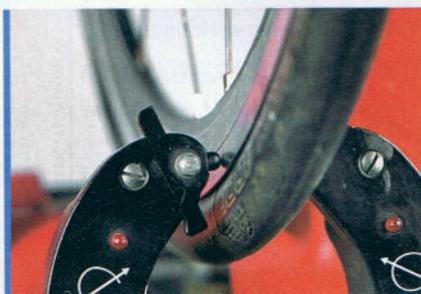
**1** Bauen Sie das Laufrad aus und spannen Sie es in einen Zentrierständer. Führen Sie die Zeiger des Zentrierständers bis auf etwa einen Millimeter an die Felgenflanken heran. Drehen Sie das Laufrad langsam durch und beobachten Sie, ob die Felge an einem Fühler streift.
